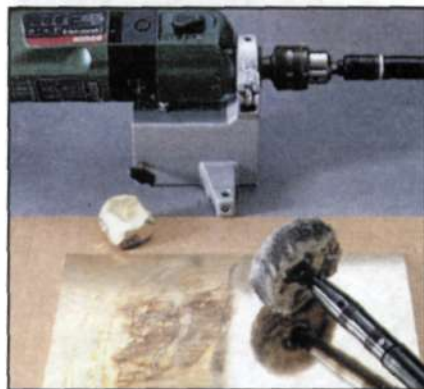
Большого эффекта можно достичь, используя полировальный круг на тканевой основе (здесь — закрепленном в патроне гибкого вала) и полировальную пасту.
