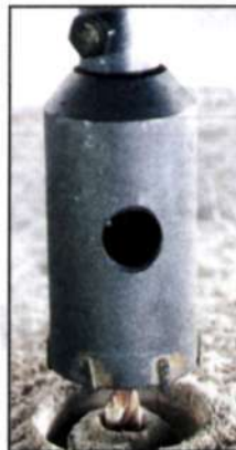
Кольцевая буровая коронка \varnothing 40-80 мм — для сверления отверстий под водопроводные, сточные и отопительные трубы, а также выключатели и распределительные коробки.
