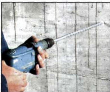
Бур делает в кирпичной стене отверстия \varnothing 8-22 мм. Сверлить можно кирпич, бетон и мрамор, пользуясь перфоратором, ударной и обычной дрелью.
