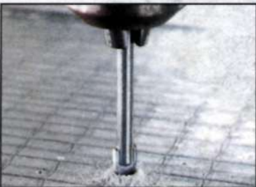
Сверла для керамической плитки и стекла имеют диаметр от 4 до 8 мм. Рассчитаны они на сверление настенной, напольной плитки, а также стекла. При сверлении такие сверла охлаждаются водой или скипидаром.
