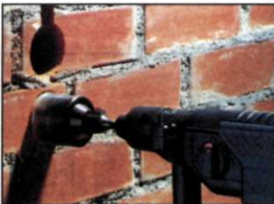
Кольцевая буровая коронка \varnothing 40-80 мм — для сверления отверстий под водопроводные, сточные и отопительные трубы, а также выключатели и распределительные коробки.
